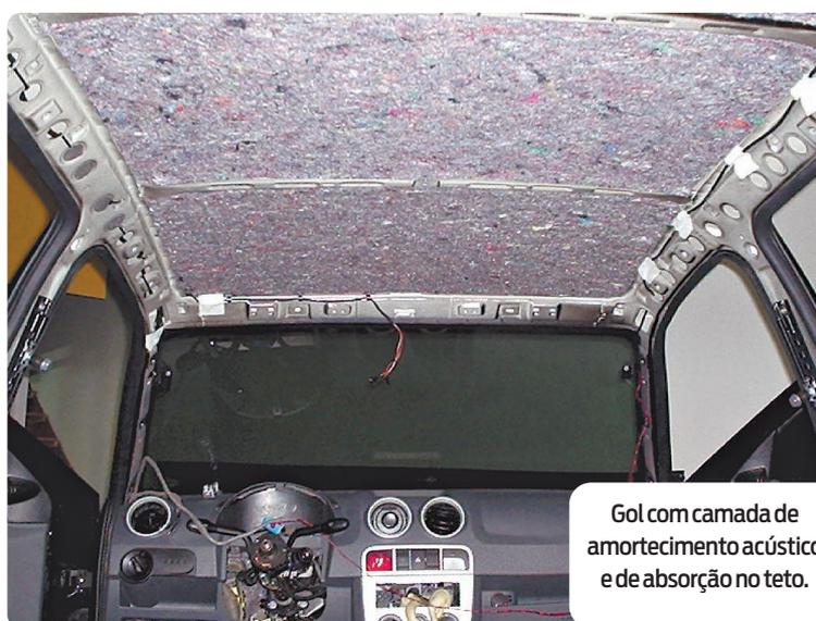
Gol com camada de amortecimento acústico e de absorção no teto.
